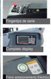
El apoyabrazos multifuncional integra el control hidráulico por fingertips, el inversor de marcha, el selector de modo de conducción, el claxon, el paro de emergencia, etc., para tener todo bajo control con la máxima precisión.
